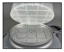
Insert the SpinVessel® tube VP 830SV-650FB into the SpinVessel® spin base.
